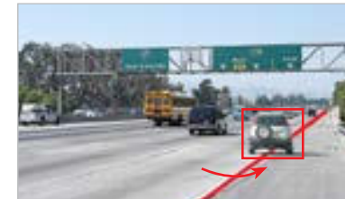
Обнаружение пересечения виртуальной линии
